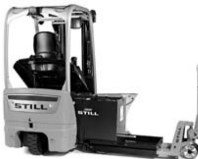
3) Смена АКБ с помощью стандартных ручных или электрических тележек и сменного блока АКБ
