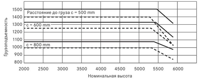
Грузоподъемности RX 20-15 тройного подъемника
