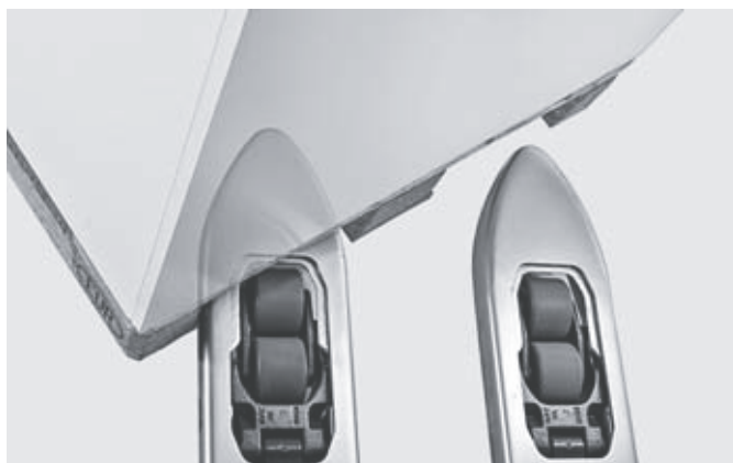
Простота загрузки палет: быстрая и точная работа благодаря закругленным вилам
